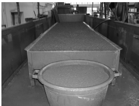
Obr. 2: Naplněný erozní kontejner s kontrolním vzorkem.
