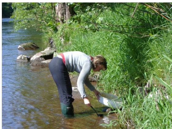
Obr. 5: Odběr sedimentu sběračkou
