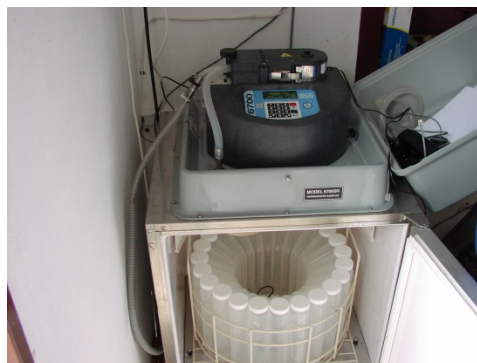
Obr. 2: Automatický vzorkovač ISCO 6700SR
