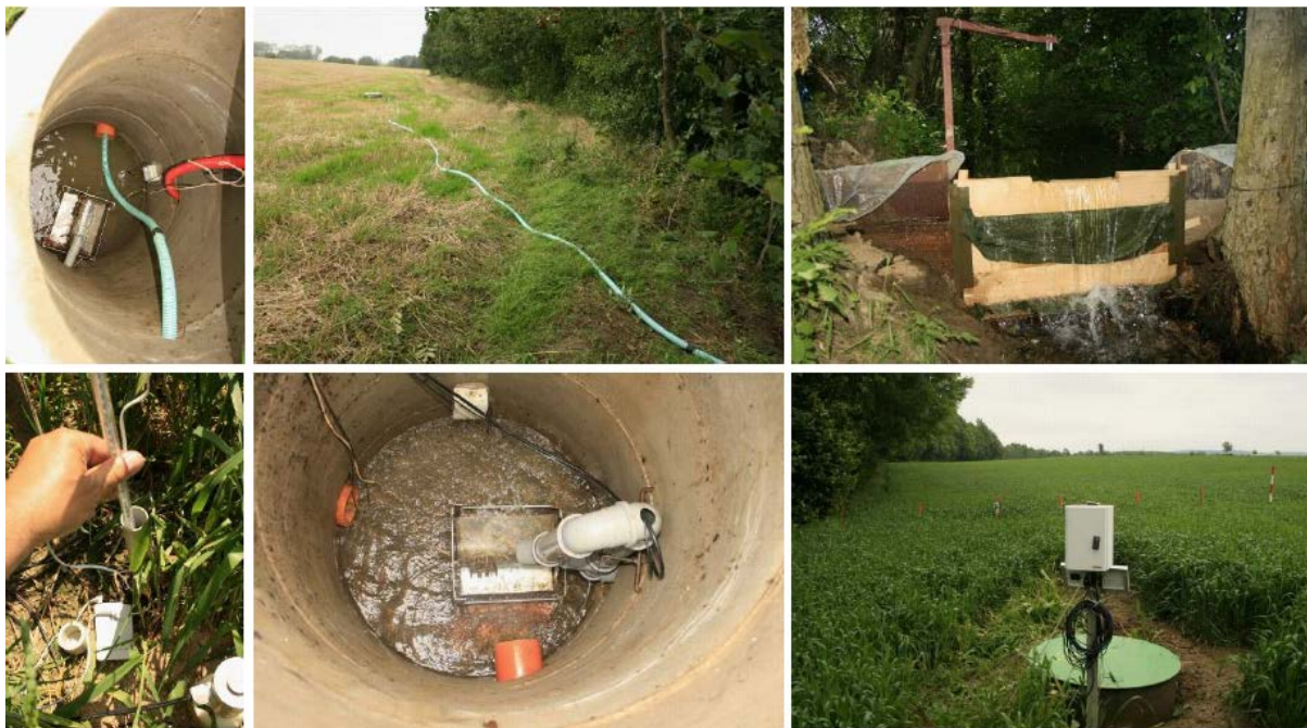
Obr. 2: Fotodokumentace vybavenosti objektů experimentální plochy. Nahoře: Š3 (měření přítoku ze ZD, zaústění N); násoska N; hrazení nádrže VN a měření hladiny. Dole: ruční měření hladin v Nortonkách; Š2 (měření průtoku a hladiny na R.P.); pohled na Š2 ve směru proti přítoku z Š3, profil PROF měření hladin a půdních vlhkostí ve 3 hloubkách.
