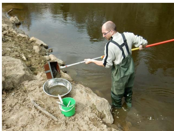
Obr. 3: Odběr sedimentu hrabákovým odběrákem
