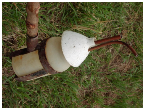
Obr. 1: Ruční vzorkovač plavenin
