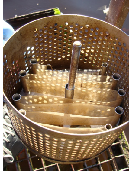
Obr. 34: Exponovaný vzorkovač SPMD před vyjmutím z nosiče a očištěním
