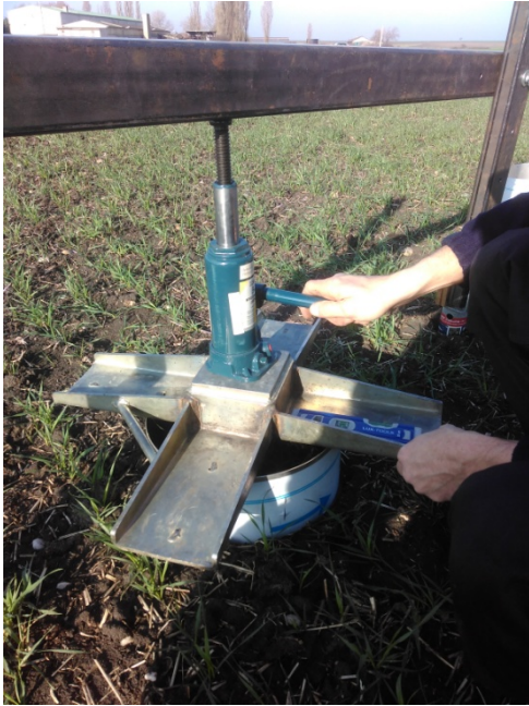
Obr. 2: Umístění infiltračního válce do půdy
