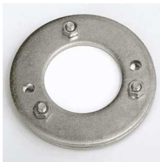
Obr. 29: Pasivní vzorkovač POCIS
