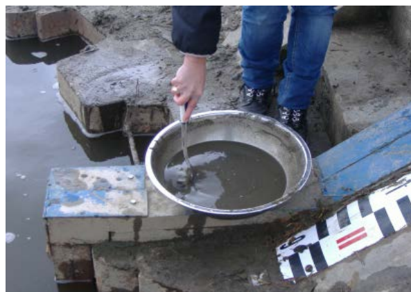
Obr. 6: Homogenizace vzorku sedimentu
