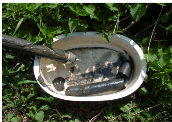
Obr. 4: Vzorek sedimentu z pístového odběráku
