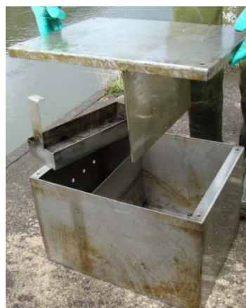
Obr. 8: Integrální vzorkovač sedimentovatelných plavenin
