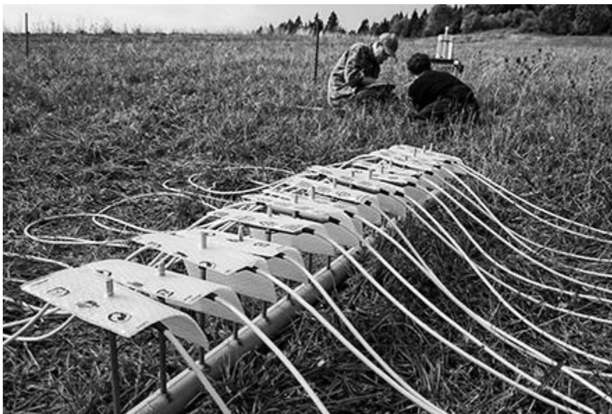
Obr. 1: Zostava na meranie elektrickej odporovej tomografie, vzadu simulátor dažďa Wageningen (Kostka a Holko, 2016)
