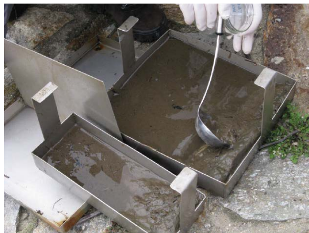
Obr. 10: Vzorek v integrálním vzorkovači
