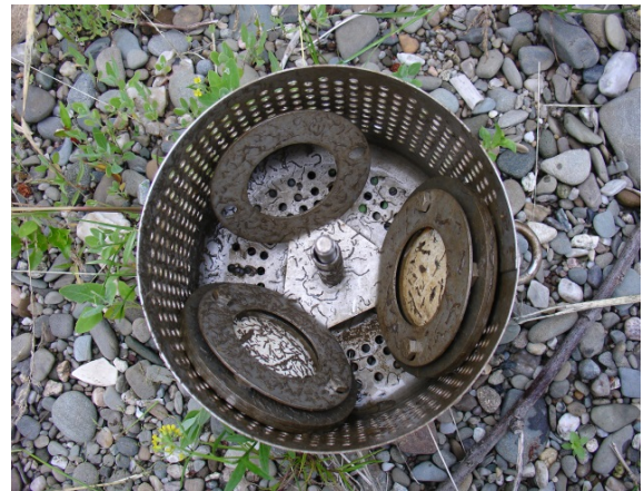
Obr. 31: Vzorkovače POCIS po expozici
