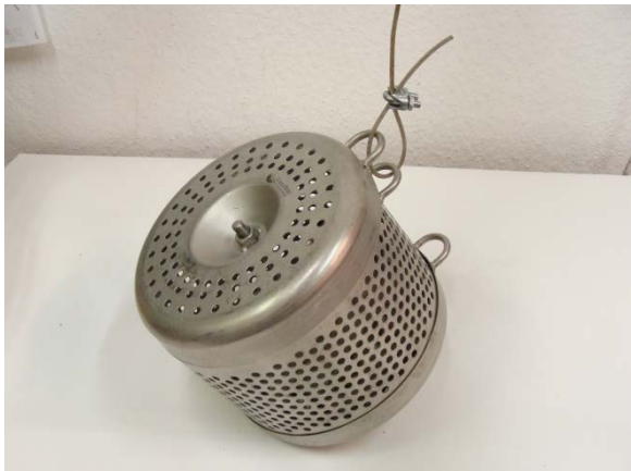
Obr. 30: Ochranný koš pro pasivní vzorkovače
