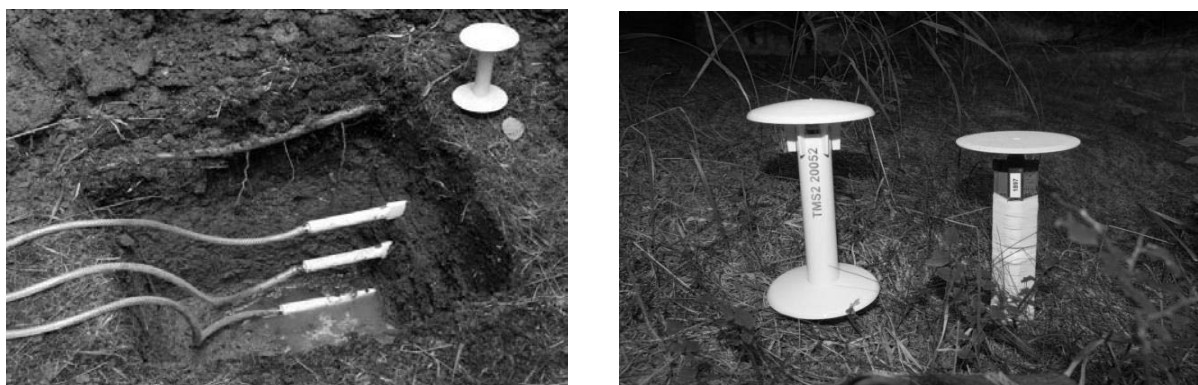
Obr. 3: Vlevo průběh instalace zakopávatelných verzí, vpravo souběžné měření dvou generací stanice (lokality Uhlířská).
