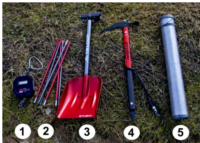
Obr. 2: Nástroje použité na meranie charakteristík snehu. Zľava: váhy WMD 03; lavínová sonda; lopatka; cepín; snehomer VS-43.
