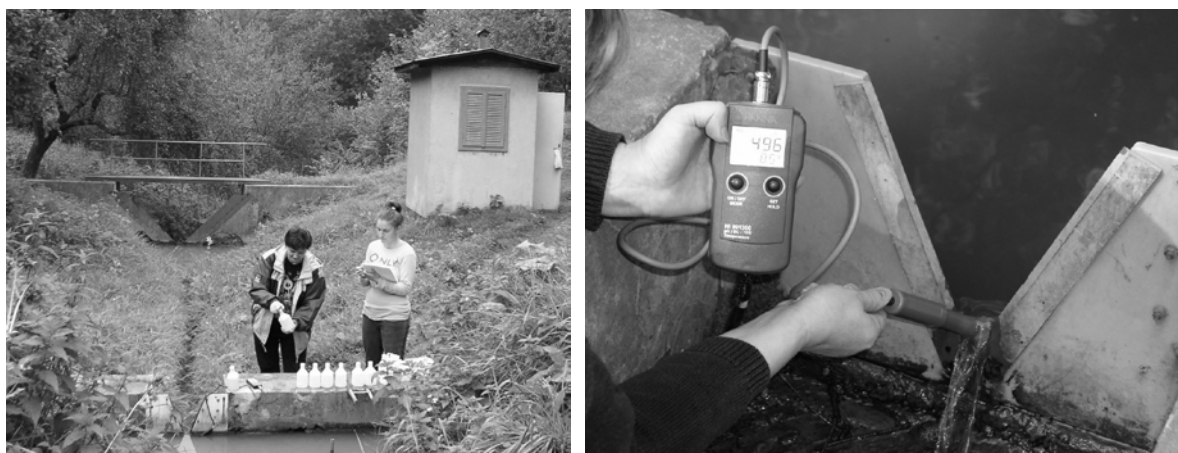
Obr. 5: Meranie mernej vodivosti (konduktivity) a odber vzoriek vody počas solných pokusov v septembri 2005 v toku Rybárik (vľavo) a v apríli 2007 v toku Lesný (vpravo).
