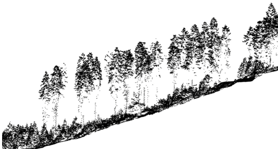
Obr. 6. Příklad vertikálního řezu porostem, který je odvozen z dat laserového skenování.
