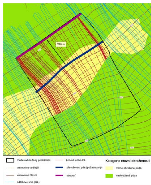
Obr. 2-31: Souvrat' S2 na spodní hranici PB/DPB doplněna o přerušovací pás ve vzdálenosti do 250 m od horní hrany souvratě proti směru odtokových linií. Další přerušovací pás není nutné aplikovat, protože vzdálenost od horní hrany prvního přerušovacího pásu proti směru odtokových linií k horní hranici plochy MEO je menší než 250 m.
