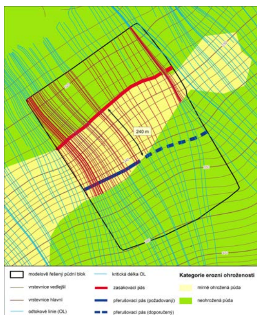
Obr. 2-25: Zasakovací pás Z2 založen na spodní hranici plochy MEO, doplněn o přerušovací pás ve vzdálenosti do 250 m od horní hrany zasakovacího pásu proti směru odtokových linií. Další přerušovací pás není nutné aplikovat, protože vzdálenost od horní hrany prvního přerušovacího pásu proti směru odtokových linií k horní hranici plochy MEO je menší než 250 m. (přerušovaně zobrazeno doporučené opatření)
