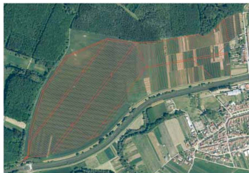
Obr. 1) Funkční schéma zakreslené do výkresu projektové dokumentace a přehledná situace na pozadí leteckého snímku: lokalita č. 1 (46,5 ha) stavby regulační drenáže Uherčice. LEGENDA: 1 – odběrný/nápnstný objekt; 2,3 – rozdělovací šachty; 4 – sdružená regulační šachta s odpadním potrubím vyvedeným do podjezí; 5 – jez na řece Svratce; K1, K2, K3 – hlavní rozváděcí PVC potrubí (závlahové i odvodňovací) světlosti Js 200 a 300 mm. Regulační - sběrné odvodňovací/závlahové drény jsou z flexibilního PVC světlosti 6,5cm.
