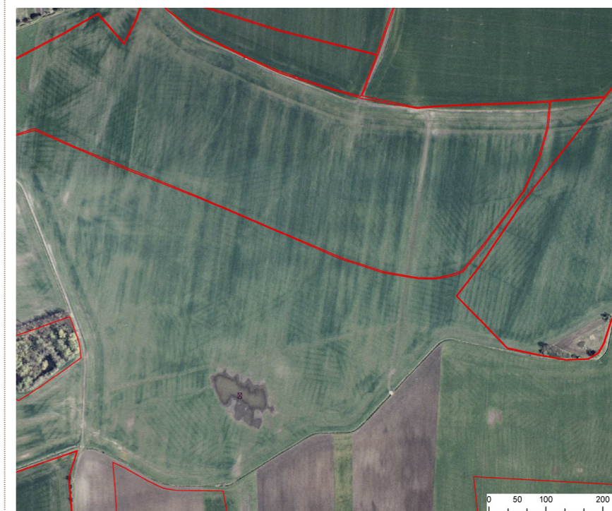
Obr. 3: Projev lokální závady drenážního systému na leteckém snímku. Na snímku jsou dobře patrné také funkční drény, vizualizované vitalitou porostu nad drenážní rýhou. Zdroj podkladu: ČÚZK (lokality JV od obce Sloveč, okr. Nymburk).
