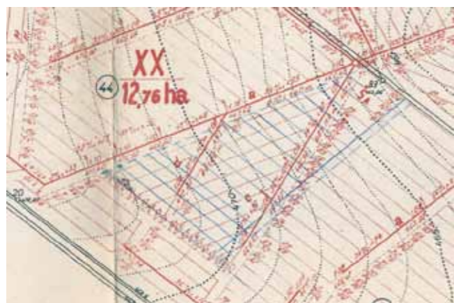
Obr. 1: Detail podrobné situace se zákresem skutečného provedení (doplněno modře).
