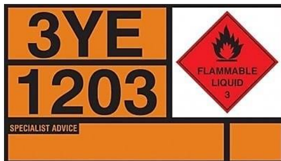
Obrázek 22 Oranžová výstražná tabulka: HAZCHEM kód – hasební látka pěna, ochrana dýchací přístroj, podle rozsahu havárie je nutné zvážit evakuaci obyvatelstva; UN kód – benzín (Systém, 2013)
